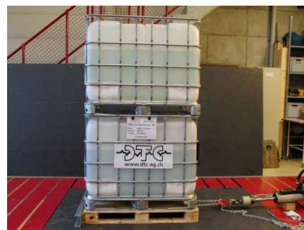
Abb. 2 : Zugversuch mit Europalette 1000kg in Längsrichtung
