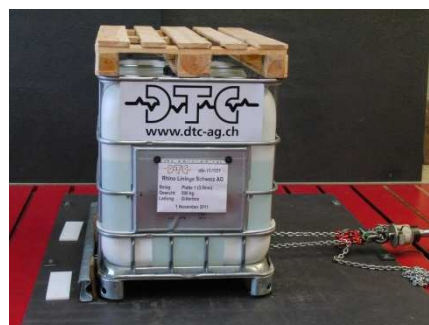
Abb. 3 : Zugversuch mit Gitterbox 500kg in Querrichtung
